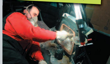
Pose de la garniture et mise en place de la fibre de verre avec de la résine liquide.
