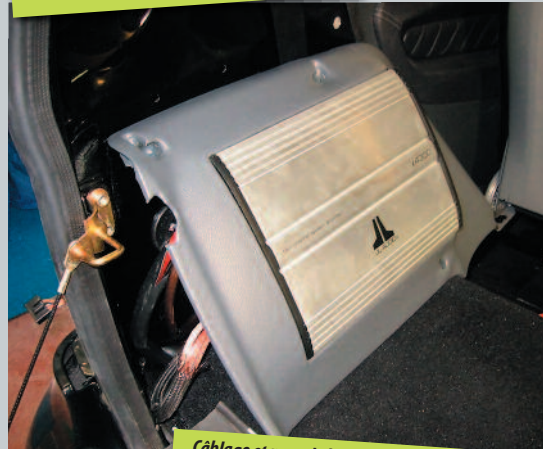
Câblage et pose de l'ampli sur la garniture.
