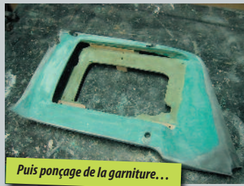
Moulage en fibre armée de l'amplificateur pour un moulage parfait...
